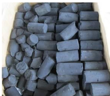
Figure 4. Briquette à 5% d'amidon + 95% de charbon de coque de noix cajou
