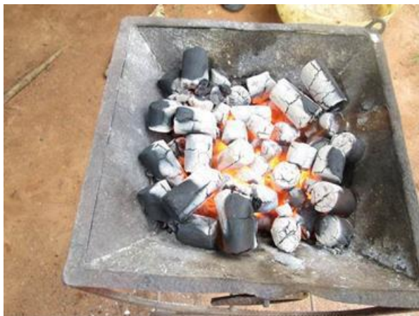
Figure 5. Test de combustion des briquettes
