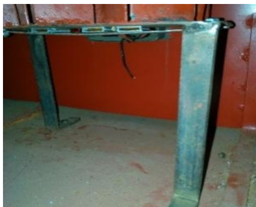
Figure 4 : Montage du dissipateur et des résistances chauffantes
