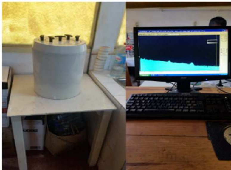
Figure 7. Image d'un appareil de spectromètre fixe (gamma et alpha) par NaI(Tl). Laboratoire de l'INSTN-Madagascar
