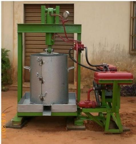
Figure 1 : Presse à Vis Manuelle (PVM) Figure 2: Presse Hydraulique Motorisée (PHM)
