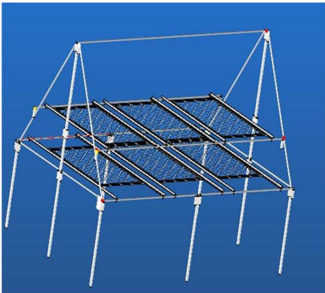
Figure 4 : Dessin en 3D du séchoir tente
