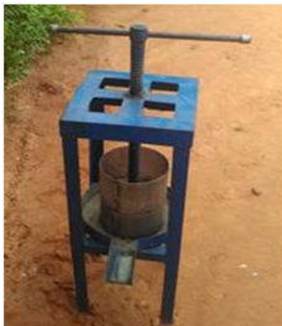
Figure 2 : Photo de la presse à vis manuelle
